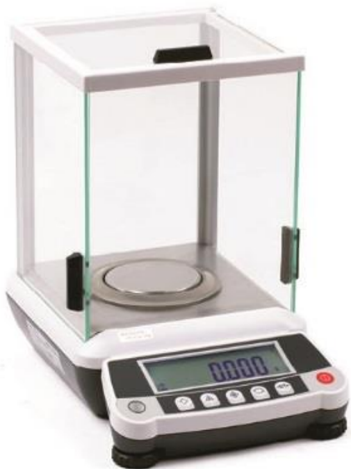
เครื่องชั่งน้ำหนักความละเอียดสูง แบบทศนิยม 4 ตำแหน่ง
